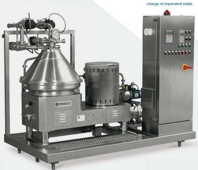
L'impiego del convertitore di frequenza permette di limitare i picchi di corrente assorbita dal motore nelle fasi di avviamento e scarico, nonché di ridurre al minimo la corrente richiesta dal motore durante il funzionamento a regime del separatore.
